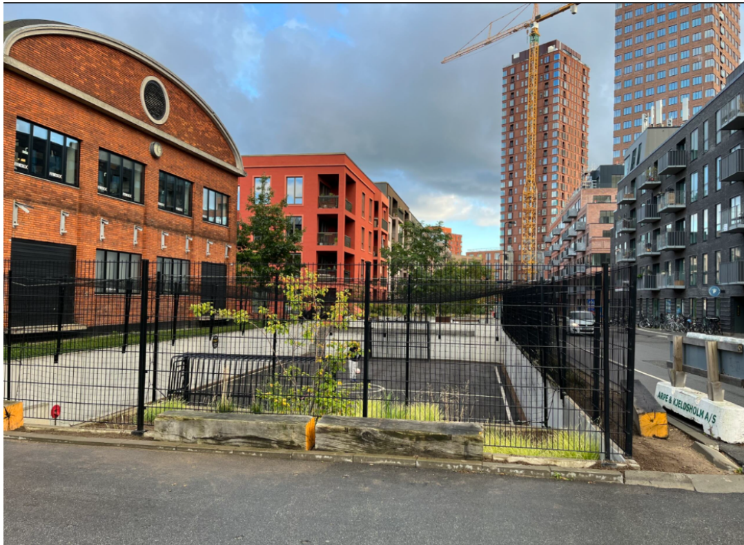
Figur 5. Bollplan som är höjdsatt för att även kunna förvara stora volymer vatten vid extrema regn, Carlsberg Byen i Köpenhamn.
